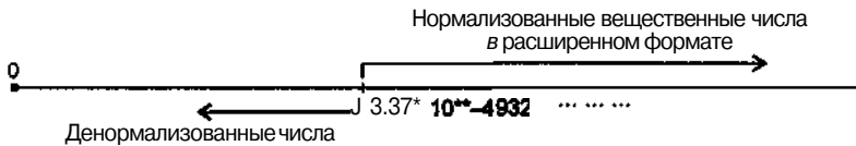
Рис. 17.11. Положение денормализованных вещественных чисел на числовой шкале
