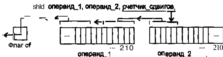
Рис. 9.6. Схема работы команды SHLD
