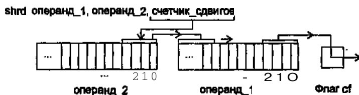
Рис. 9.7. Схема работы команды SHRD
